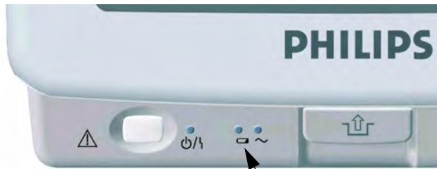
Voyant des batteries
