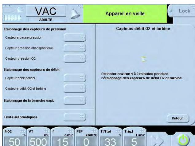
L'étalonnage se déroule de manière automatique. Le capteur de débit patient étant étalonné, il devient le capteur étalon ; l'étalonnage peut alors se faire en interne.
