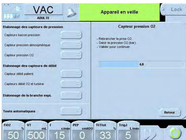
Une fois la pression stabilisée, tourner la molette pour régler sur **MONNAL T75** la valeur de la pression lue sur le système de surveillance de la pression de l'oxygène d'alimentation.
