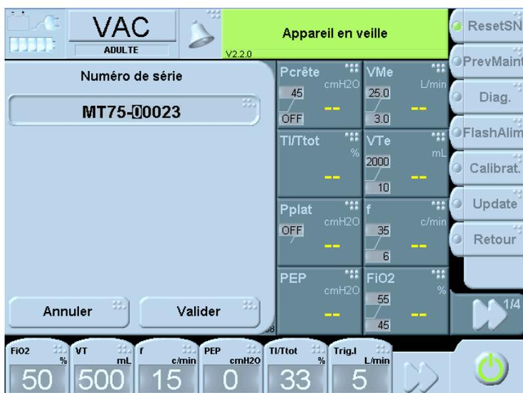
Déplacer à l'aide de la roue codeuse le curseur qui apparaît en vidéo inversé pour sélectionner le Chiffre à modifier, appuyer sur la roue codeuse puis la faire tourner en sens horaire pour incrémenter ou en sens antihoraire pour décrémenter. Une fois le numéro de série souhaité complètement saisi, sélectionner « **valider** » Le nouveau numéro est pris en compte.
