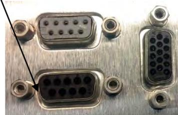
Connecter le câble au port de communication du ventilateur sans le connecter au port COM du PC dans un premier temps.
