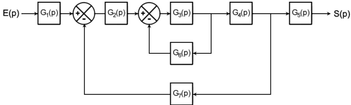
À partir du schéma initial, déterminer la fonction de transfert en boucle fermée  $H_{bf}(p) = \frac{S(p)}{E(p)}$
